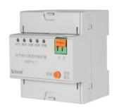
ASCP10-1 型电气防火限流式保护器是安科瑞电气专门为了保护低压配电线路中短路、过载等问题研发,单相线路保护,额定电流20A。可以有效克服传统断路器、空气开关和监控设备存在的短路电流大、切断短路电流时间长、短路时产生的电弧火花大,以及使用寿命短等弊端,发生短路故障时,能以微秒级速度快速限制短路电流以
