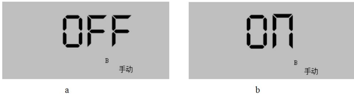
图 24 B 相控控制 a: 切除; b: 投入
