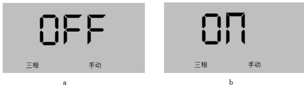
图 89 共补手动控制 a: 切除; b: 投入
