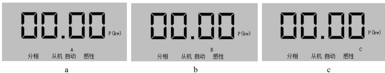
图 83 有功功率 a: A相有功功率; b: B相有功功率; c: C相有功功率
