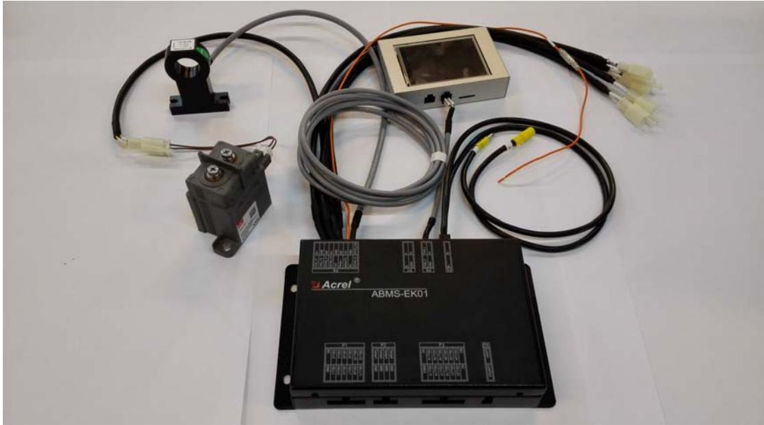
图 18 管理系统上侧面接线实例图
