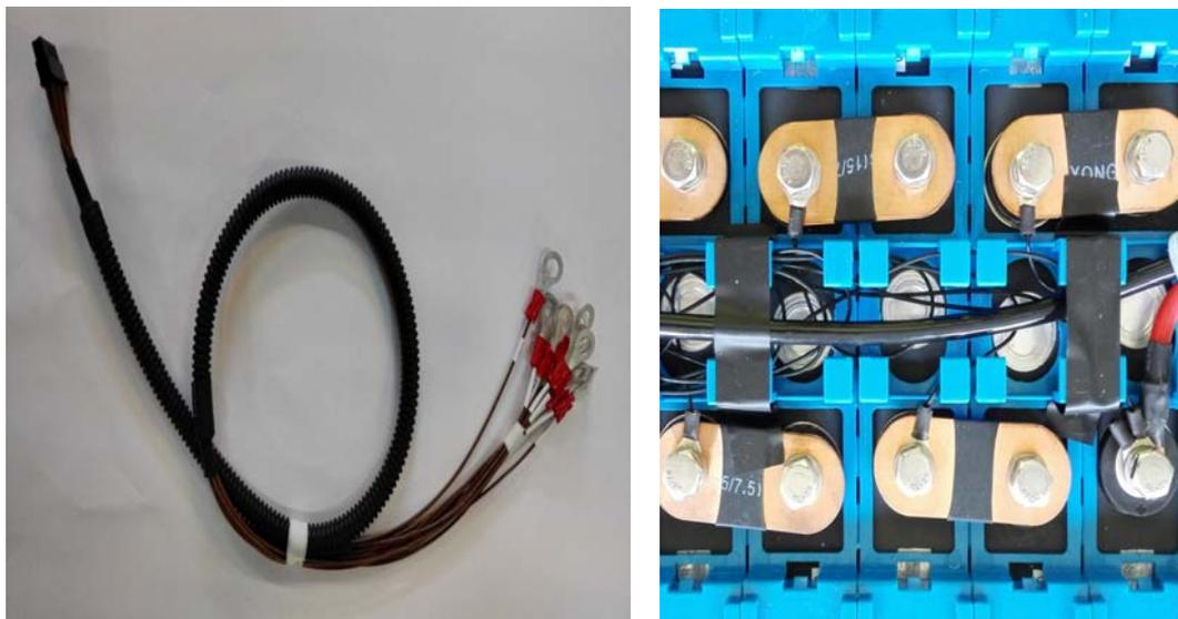
图 14 第 13~24 串电压检测排线与电池的连接实例图
